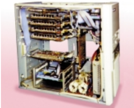
Рис. 1. Компьютерный блок системы управления
